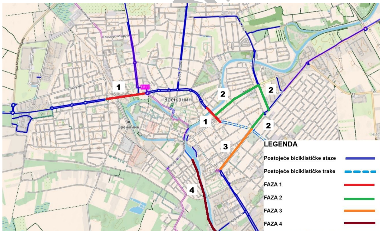
Ilustracija 7-9 Predlog deonica za proširenje postojeće biciklističke infrastrukture u Gradu Zrenjaninu po fazama izgradnje
