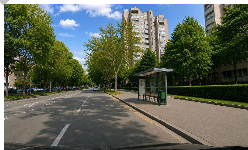
Ilustracija 7-11 Primer pozicioniranja autobuskog stajališta uz kolovoz kako bi se omogućilo nesmetano kretanje pešaka
